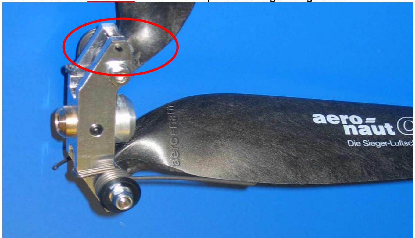
Stifte stützen das Propellerblatt beim Überdrehen ab.
